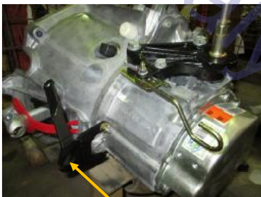
براکت نگهدارنده کابل کلاچ
